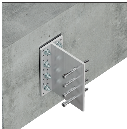
BTCALU przymocowany do betonu za pomocą kotwy opaskowej FM 753 evo. Usunięto belkę drewnianą, aby pokazać położenie sworzni w profilu. Należy zwrócić uwagę na zastosowanie membrany ochronnej LDPT pomiędzy aluminium a powierzchnią styku z betonem.
