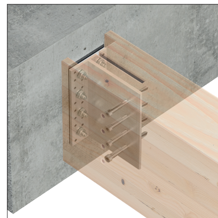
BTCALU przymocowany do betonu za pomocą kotwy opaskowej FM 753 evo i sworzni STD zainstalowanych w profilu.
