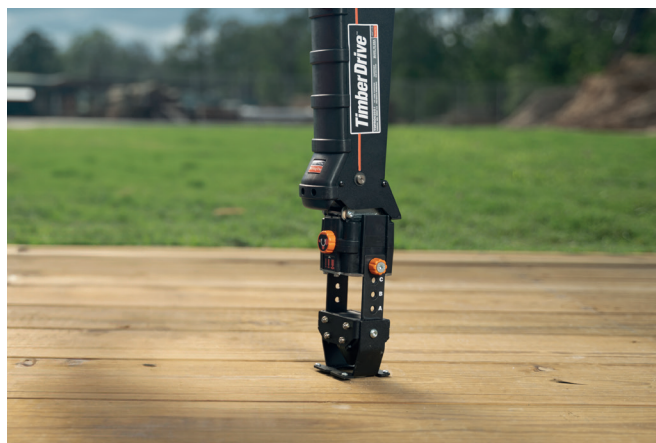
Płyta czołowa do zastosowań drewno-drewno.
