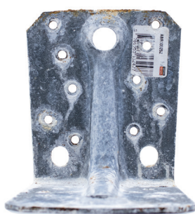
Złącze z powłoką ZPRO Tworząca się rdza na krawędziach zostaje pokryta ochronnym osadem magnezu.
