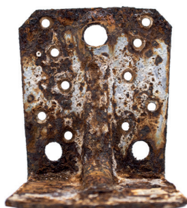
Złącze z powłoką ze stali ocynkowanej Z275 Większość złącza jest całkowicie zardzewiała.
