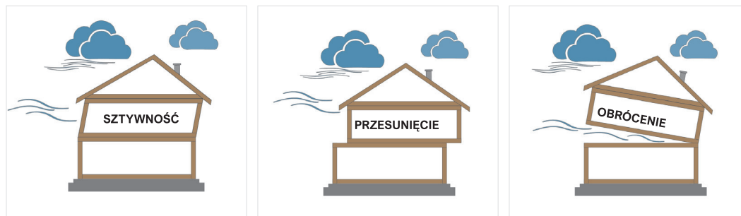
Zdj.5.4 Schematy zniszczenia wyższych kondygnacji budynku szkieletowego
