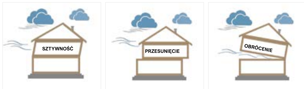
Zdj.5.4 Schematy zniszczenia wyższych kondygnacji budynku szkieletowego
