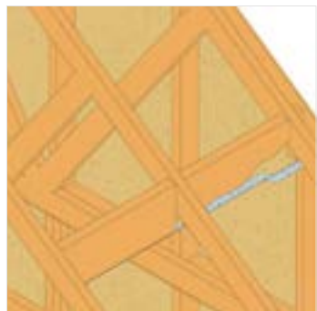
Zdj.9.6 Połączenie ściany szczytowej z więźbą złączami ciesielskimi
