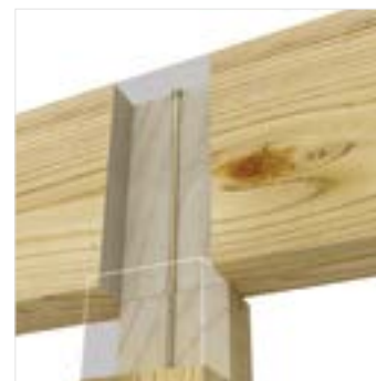
Zdj.8.6 Połączenie belek ze słupem
