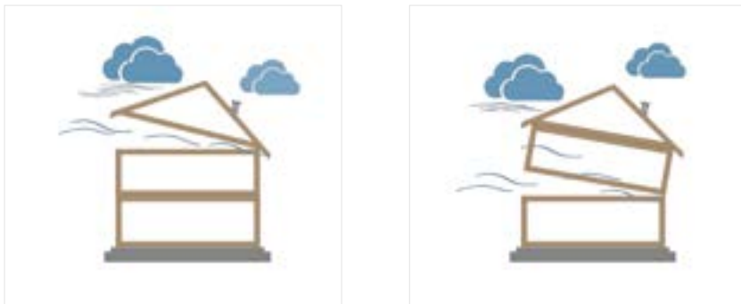
Zdj. 1.5 Fragmentacja konstrukcji budynku drewnianego
