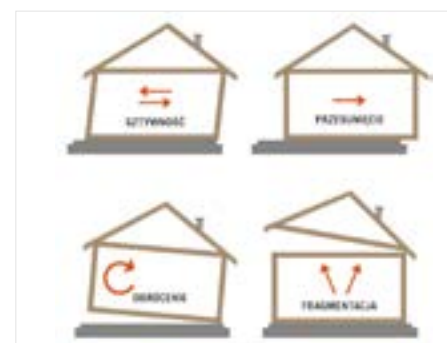
Zdj. 1.1 Modele zniszczenia uwzględniane w budynkach szkieletowych
