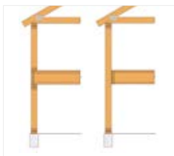
Zdj. 6.1 Układy konstrukcyjne platformowy i balonowy.
