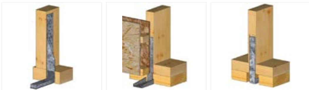
Zdj.4.8 Możliwości ukrycia dolnej części dwuczęściowego złącza kotwiącego
