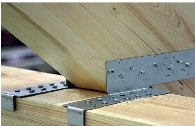
Zdj. 6. Złącze SFH przenosi rozpór z krokwi i zabezpiecza murlatę przed rozwarstwieniem
